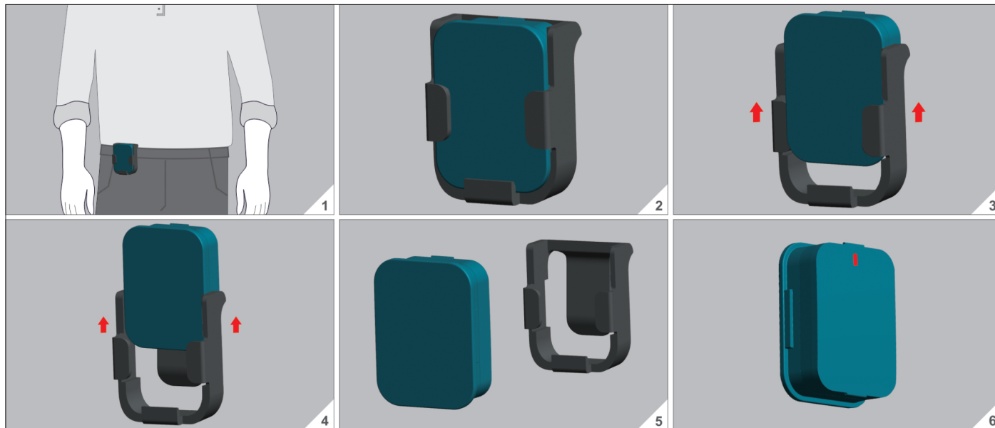
Figure 22: Instructions pour retirer le dispositif de suivi PDMonitor® attaché à la taille à l'aide d'une monture avec attache
