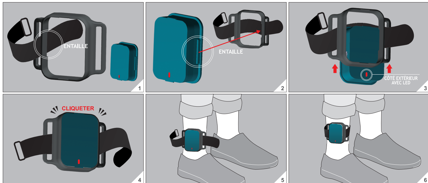
Figure 15: Instructions pour fixer les dispositifs de suivi PDMonitor® au niveau des tibias à l'aide de la monture pour sangle
