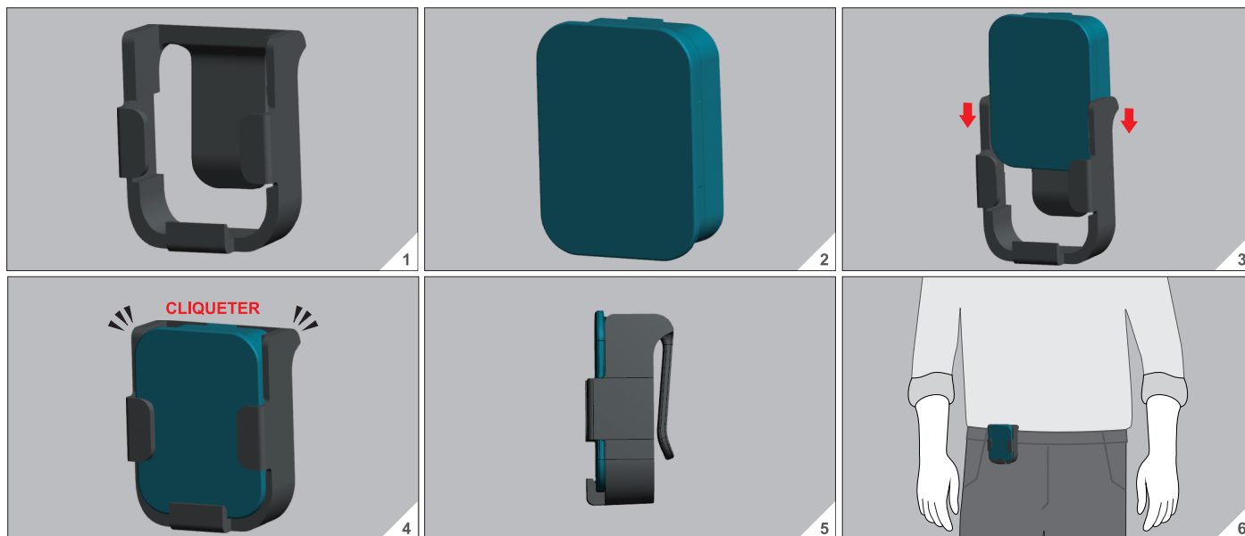
Figure 17: Instructions pour fixer les dispositifs de suivi PDMonitor® à la taille à l'aide de la monture avec attache
