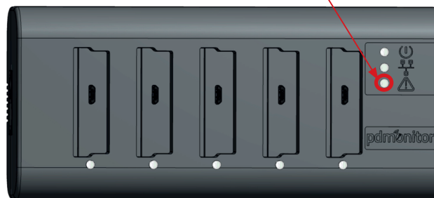
Voyant lumineux de l'alarme
